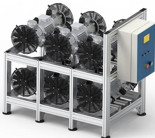
Централизованный агрегат CENTRALAIR 6 представляет собой сухой компрессор с производительностью 2700 л / мин при 5 бар и регулируемым максимальным давлением от 8 до 10 бар. Блок управления может регулировать работу насосных элементов таким образом, чтобы гарантировать постоянное давление в системе.
